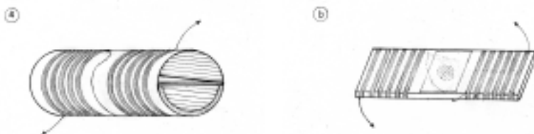
Fig.5 - Disegni illustrativi di bobine di Helmholtz impiegate negli esperimenti.
